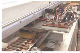
永久磁石レスリニアモータとインバータ 可変界磁リニアモータ
