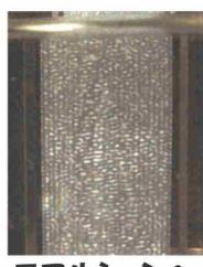
エマルジョンへの超音波照射で凝集した油滴
