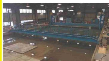
海洋波動実験棟の平面水槽
