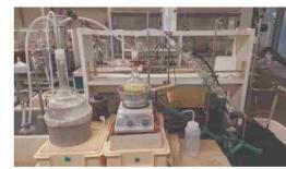
水蒸気蒸留装置
